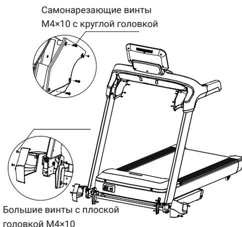
Шаг V: Внимательно осмотрите крепление каждой части беговой дорожки; запустите беговую дорожку на низкой скорости и проверьте гибкость вращения каждой части бегового полотна и натяжение бегового полотна; преваляется отсутствие смещения и проскальзывания бегового полотна (см. «Ежедневное обслуживание и уход за электрической беговой дорожкой»). После осмотра переместите беговую дорожку в правильное положение для использования.
