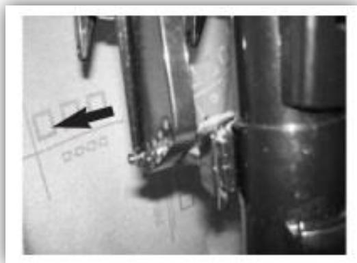
Испытайте лодку в движении, чтобы установить, какой угол дифферента наиболее подходит для Вашей лодки и для конкретных условий её эксплуатации. При постановке регулировочного прута на одно отверстие угол дифферента меняется примерно на 4 градуса.
