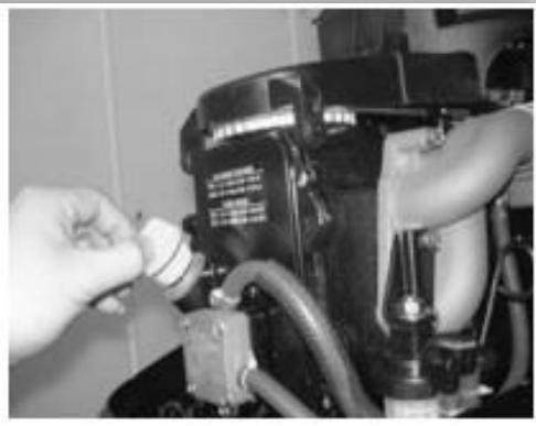
Масло необходимо сменять чаще, если мотор эксплуатируется в сложных условиях, например, при продолжительном лове с движущейся лодки.
