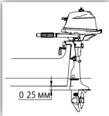
Если концы лопастей гребного винта режут воздух, число оборотов двигателя возрастёт до ненормальных пределов, что приведёт к перегреву двигателя.
