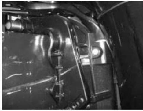
1. Слегка откиньте мотор вверх, пока подпорный стержень для откидывания не высвободится автоматически.
