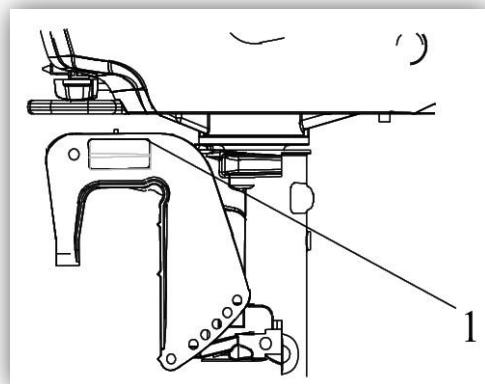
(1) Серийный номер подвесного лодочного мотора.
