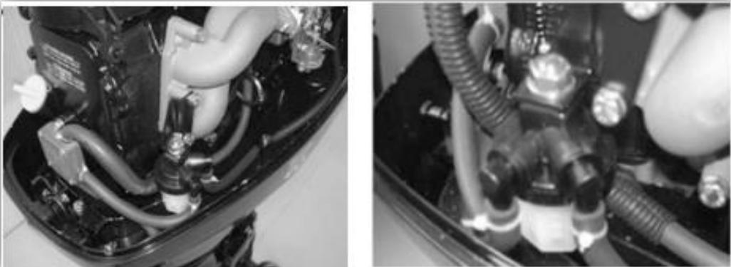
4. Утечка топливного соединителя
