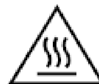
ПРЕДУПРЕЖДЕНИЕ: Не прикасайтесь к горячей поверхности!
