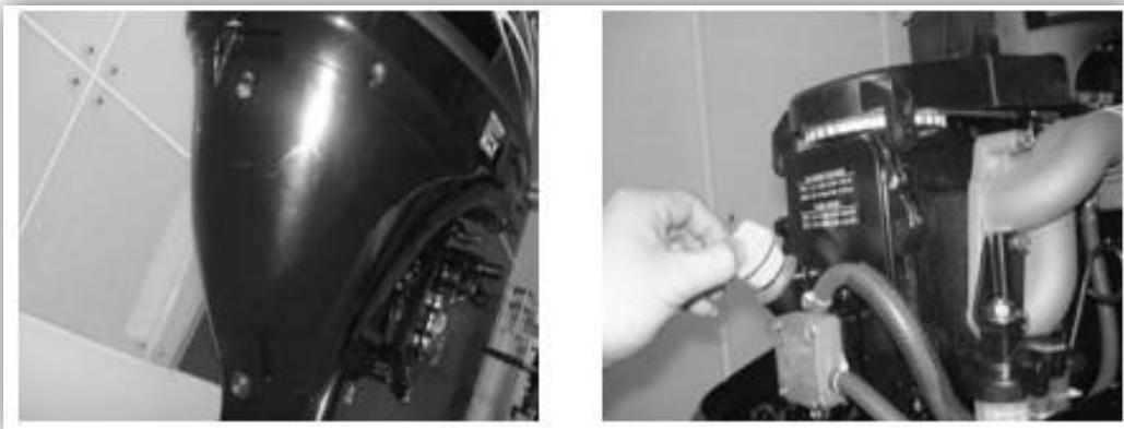
3. Установите новую прокладку на сливной болт. Нанесите тонкий слой масла на прокладку и установите сливной болт на место.
