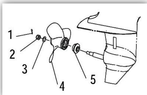
2. Установите упорную шайбу и гребной винт на гребной вал.
