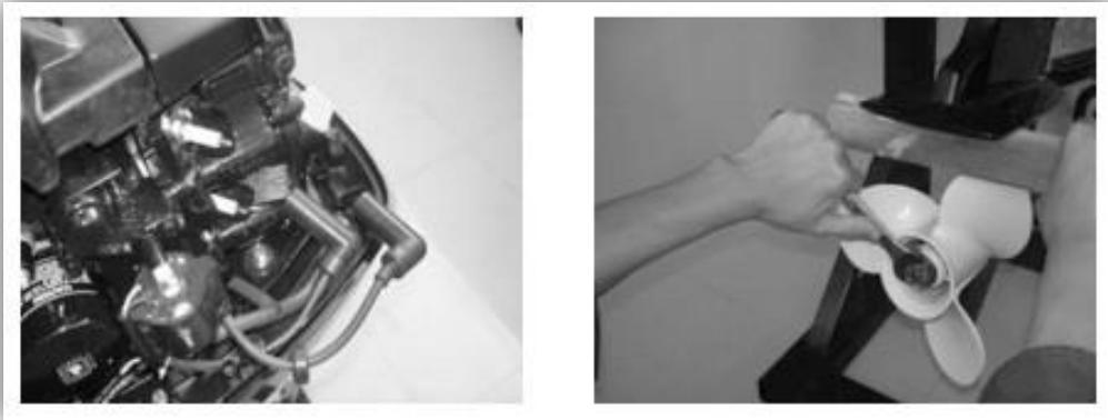
Снимите гребной винт и упорную шайбу.
