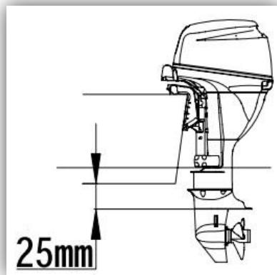
Если концы лопастей гребного винта режут воздух, число оборотов двигателя возрастёт до ненормальных пределов, что приведёт к перегреву двигателя.
