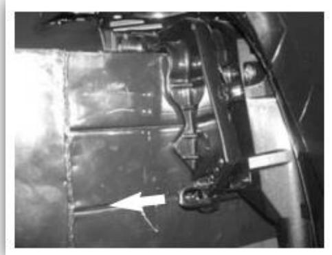
Испытайте лодку в движении, чтобы установить, какой угол дифферента наиболее подходит для Вашей лодки и для конкретных условий её эксплуатации. При постановке регулировочного прута на одно отверстие угол дифферента меняется примерно на 4 градуса.
