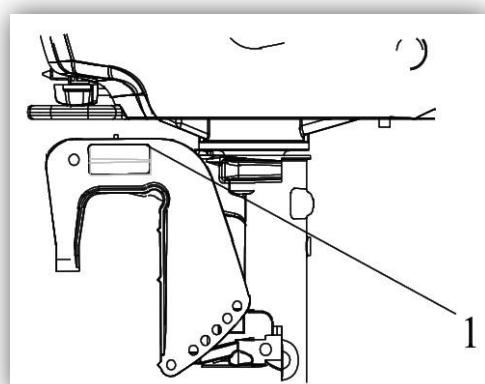
(1) Серийный номер подвесного лодочного мотора.
