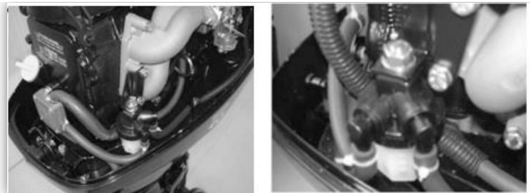
Осмотрите топливную магистраль на предмет наличия утечек, трещин и неполадок. Если Вы обнаружите неполадки, их должен будет устраниить в срочном порядке опытный механик или местный дилер Mikatsu.
