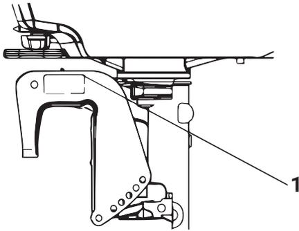
1 — серийный номер подвесного лодочного мотора.
