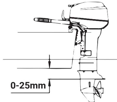
Если концы лопастей гребного винта режут воздух, число оборотов двигателя возрастёт до ненормальных пределов, что приведёт к перегреву двигателя.
