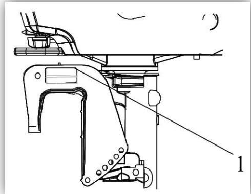
(1) Серийный номер подвесного лодочного мотора.
