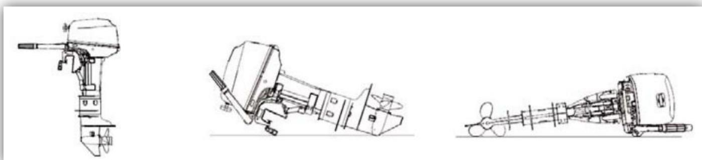
Для перевозки и хранения снятого с лодки подвесного мотора сложите рукоятку румпеля и облокотите на неё мотор, чтобы он находился в горизонтальном положении. Подложите под мотор плотный материал, чтобы уберечь мотор от повреждений при перевозке.
