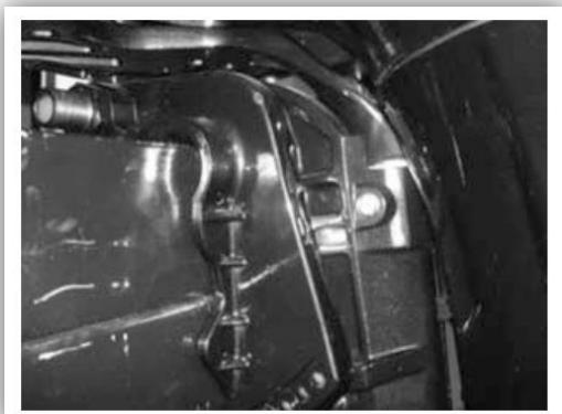
3. Отключите от мотора соединитель топливного шланга.
