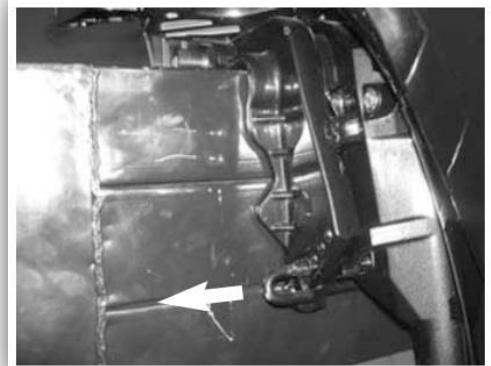
Чтобы приподнять носовую часть лодки, установите регулировочный прут дальше от транца. Чтобы опустить носовую часть лодки, установите регулировочный прут ближе к транцу.
