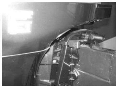
5. Придерживая заднюю часть верхнего кожуха рукой, полностью откиньте мотор вверху.
