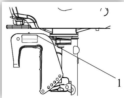
(1) Серийный номер подвесного лодочного мотора.
