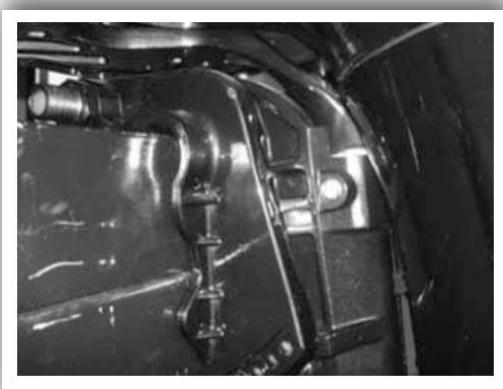
3. Отключите от мотора соединитель топливного шланга.
