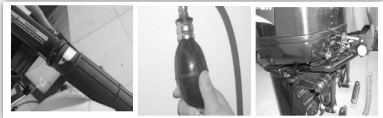
**Замечание.** Пользоваться воздушной заслонкой необязательно, если Вы снова запускаете ещё тёплый двигатель. Если после того, как двигатель заведётся, Вы не вернёте ручку воздушной заслонки в первоначальное положение, двигатель заглохнет.
