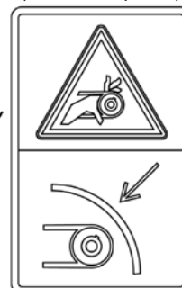
91195-019 ЭТИКЕТКА «ОСТОРОЖНО, ЗАЩИТНЫЙ КОЖУХ РЕМНЯ» (слева/справа)
