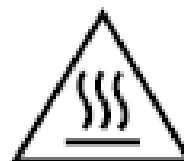
Выключите двигатель перед ТО. Осторожно! Горячая поверхность.
